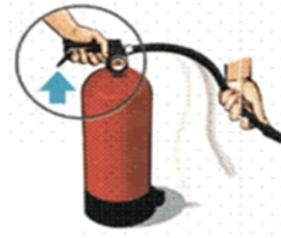
Pressionar a válvula para testar o seu funcionamento.
